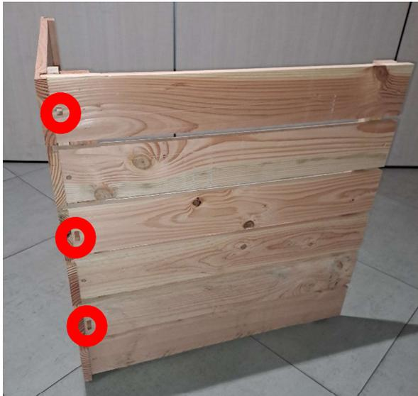
Le côté gauche s'installe et se fixe de la même façon, avec 3 chevilles :
