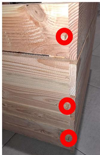
La partie basse de la façade s'insère par le haut dans les rainures des deux côtés. Faire attention au sens d'introduction. La partie évidée de la planche doit se trouver à l'extérieur.
