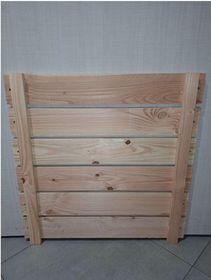
3) D'un côté droit, dont les planches sont rainurées en totalité sur la gauche pour permettre l'insertion du fond et partiellement sur la droite pour permettre l'installation de la façade.
